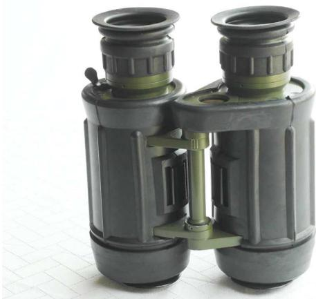
Abbildung 1.6: Zeiss Jena EDF 7x40 der NVA (Sehfeld: 131m/1000m)
