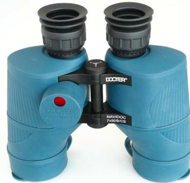
Abbildung 1.10: Docter 7x50 NAVIDOC mit Kompaß (Sehfeld: 128m/1000m). Auffällig sind die Teleskopaugenmuscheln, die das von der Seite einfallende Streulicht effektiv abschirmen.
