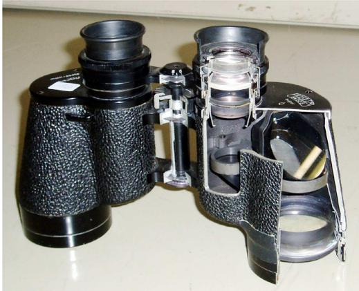
Abbildung 1.4: Schnittmodell des 8x50 Nobilem Super von Carl Zeiss Jena (Sehfeld: 140m/1000m), ein Nachtglas mit großem Sehfeld und breiter stereoskopischer Basis
