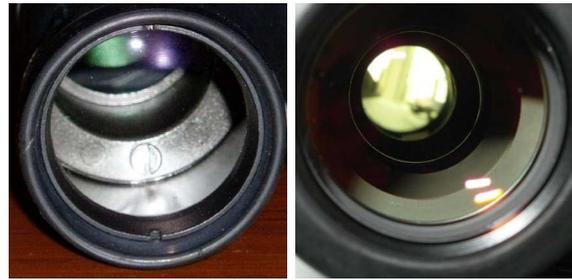
Abbildung 2.3: Der Blick in den Tubus. Links: Imitat eines Militärfernglases mit metallisch spiegelnden Wänden. Rechts: Streulichtblenden im Zeiss Jena 7x40 EDF (die Reflexe stammen vom Blitzlicht, das an den Objektiven reflektiert wurde)
